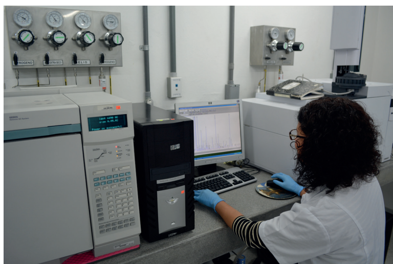
Fig. 6. Cromatógrafo de gases con detección de ionización de flama (FID) utilizado principalmente para análisis de ácidos grasos metil-esterificados, de esteroles y de isómeros del ácido linoleico conjugado (Foto H. Acosta Salmón).
