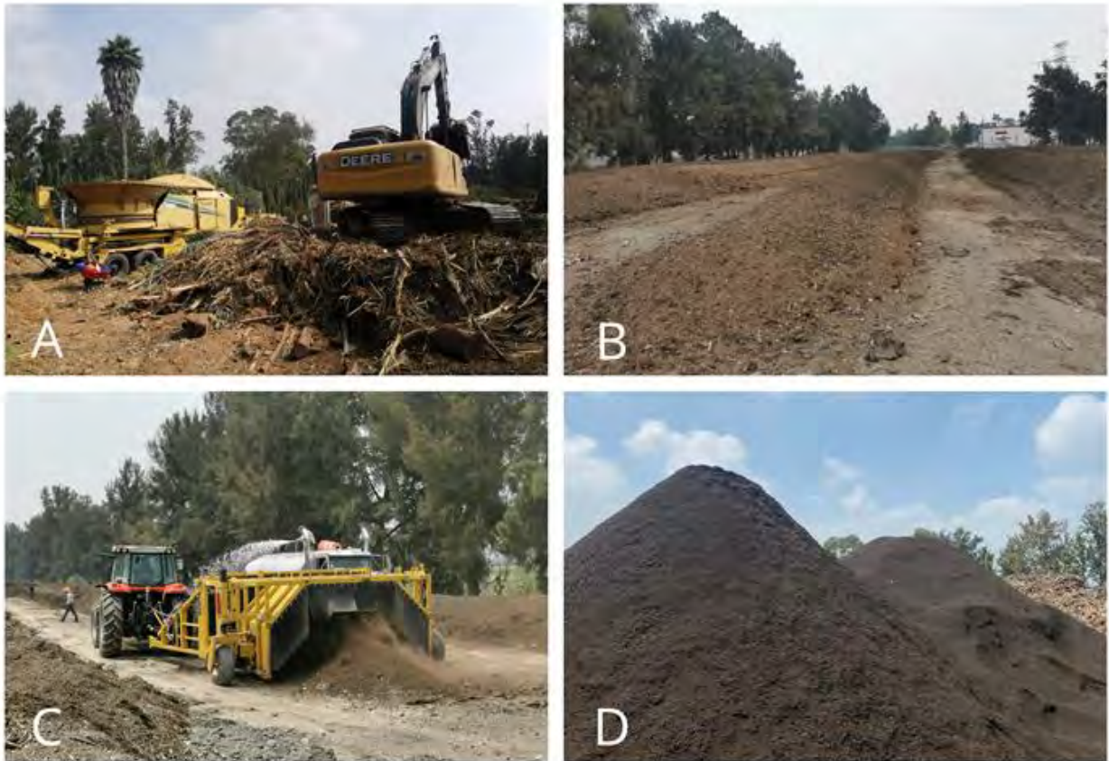
Figura 2. Proceso de compostaje. A) triturado de residuos de palma canaria; B) conformación de pilas de compostaje; C) volteo mecanizado y riego; D) pilas de composta madura.
