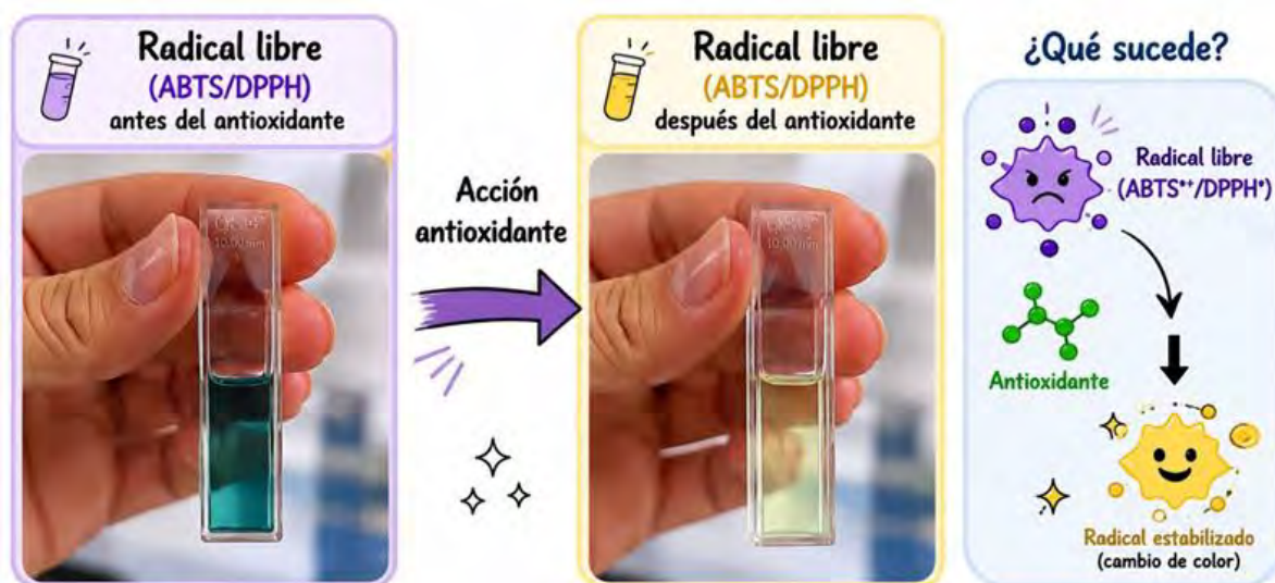
Figura 5. Cambio de color en los ensayos ABTS y DPPH. En presencia de compuestos antioxidantes, los radicales libres (de color azul-verde o morado intenso) se estabilizan, provocando la decoloración de la solución, la cual puede medirse mediante espectrofotometría.
