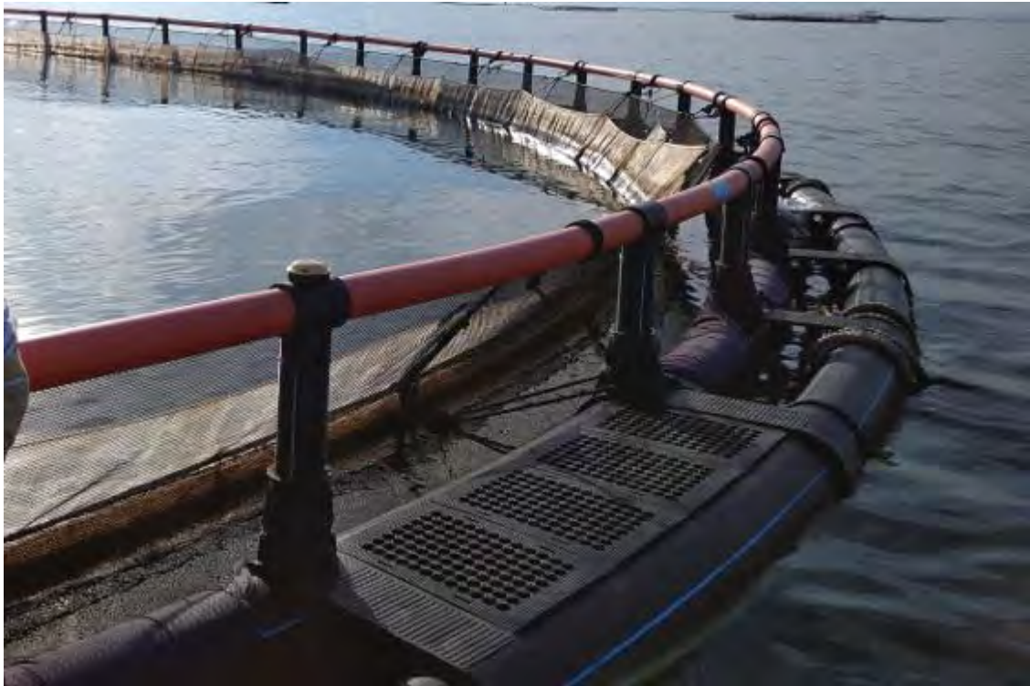
Figura 2. Jaula flotante de HDPE para cultivos marinos en zonas de alta mar. Tomada de STARAQ.
