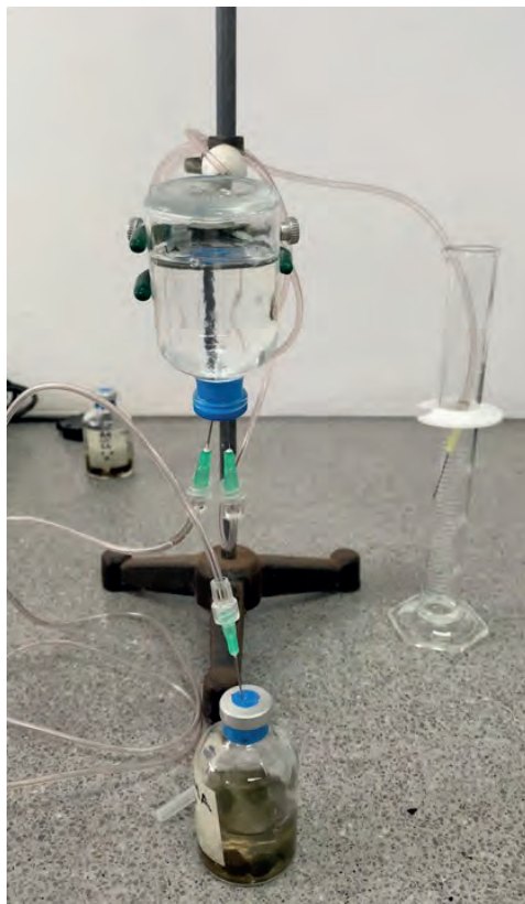
Foto: Dispositivo para medir el desplazamiento de volumen para estimar la producción de biogas (metano, dióxido de carbono e hidrógeno), en botellas que contienen muestras de tapete microbiano. La botella invertida contiene una solución de NaOH 1N, que funciona para atrapar el dióxido de carbono. El gas (metano) que desplaza el volumen de NaOH se mide en la probeta de lado derecho.
